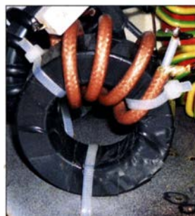
Bild 9: Breitbandübertrager mit 4 Wdg. PTFE-Koaxialkabel auf einem dem FT240-43 ähnlichen, jedoch etwas höheren Kern
