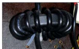
Bild 7: Spule L1 auf zwei gestapelten T300-2 im Fuchskreis mit Abgriffen und 26-stufigem Drehschalter
