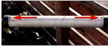
Bild 5: Sperrkreis von unten; die Pfeile markieren die Entlüftungslöcher.
