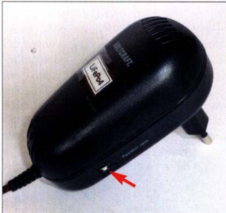
Steckernetzteil Voltcraft SPS24-24W-A mit Eurostecker und Weitbereichseingang; markiert ist die Position für die Spannungssteckbrücke.
