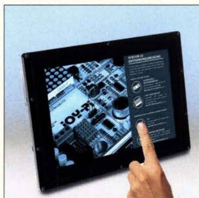
Der LCD10 V2 lässt sich in Geräte einbauen oder als eigenständiger Bildschirm betreiben – beides mit Touchscreen-Funktion.
