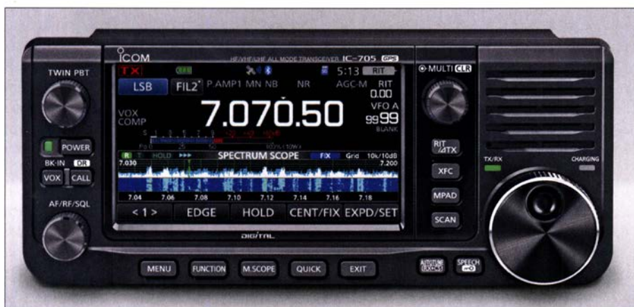
Bild 1: Das Design ist vom Display geprägt, auffallend die im Vergleich zum IC-7300 bzw. IC-9700 reduzierte Anzahl von Tasten.
