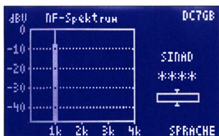
Bild 12: NF-Spektrum des 1-kHz-Testsignals am Ausgang des Tschebyscheff-Filters
