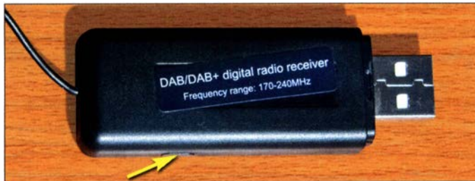
Bild 1: Der DAB+-MP3-Stick sieht eher „gebastelt“ aus; links unten und hier kaum erkennbar befindet sich der Taster für den Bandsuchlauf.
