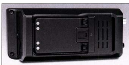
Bild 2: Fast zwei Drittel der Rückseite beansprucht die Aufnahme für den Li-Ionen-Akkupack – kein Platz mehr für Buchsen.
