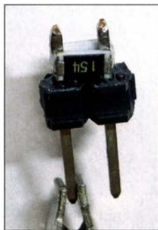
Eine Krokodilklemme ist als Kühlung an die Stifte zu klemmen, die zweite hält die beiden SMD-Widerstände beim Löten fest.
