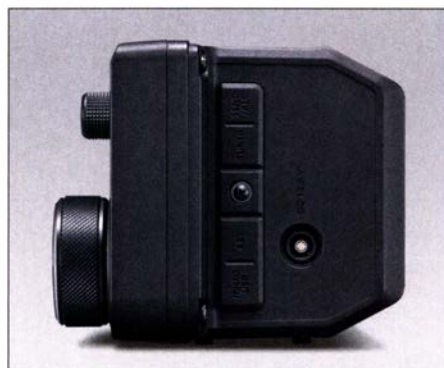
Bild 4: Rechte Seite; unter Abdeckungen die Buchsen für Stromversorgung, Taste, Tuner und Endstufe sowie der Micro-USB-Port
